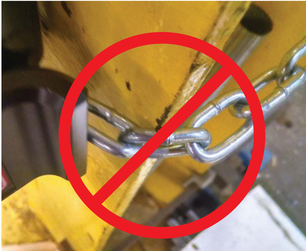
Figura 2.17 evite dobrar a corrente em cantos
