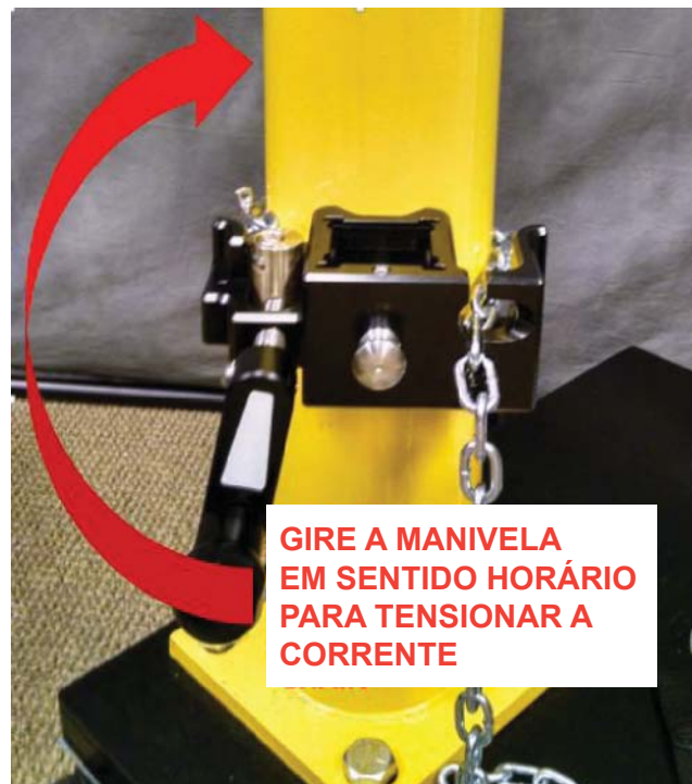
Figura 2.26 tensionando a corrente
