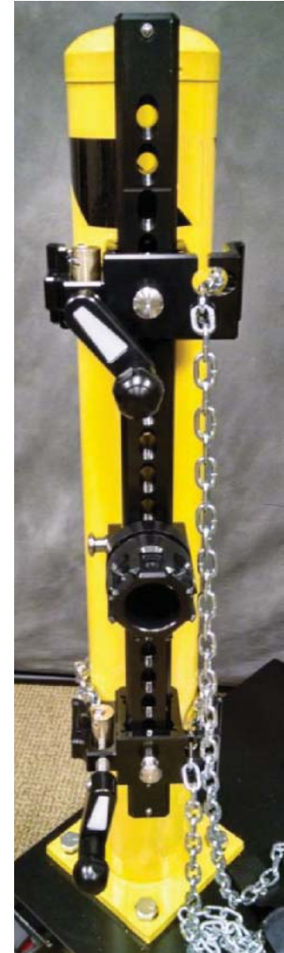
Figura 2.30 instalação do pino passante na montagem
