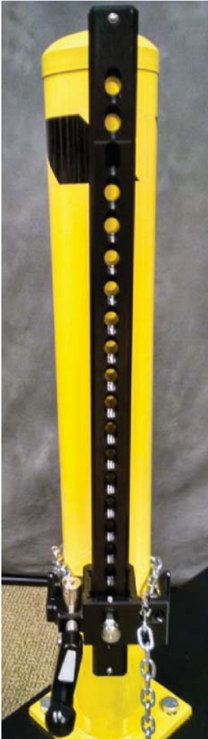
Figura 2.28 instalação da barra de montagem
