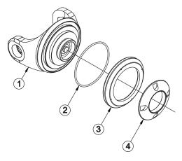
MODEL ZAAD\* -- ALUMINUM HALF BALL WITH INTERNAL DRAIN
